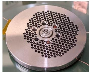
毎秒一回転の遅い回転速度から1mWを出力する発電機の開発
